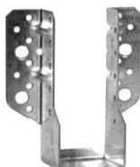
LE SABOT À AILES EXTÉRIEURES SBE PERMET UNE REPRISE DE CHARGE SEMBLABLE AU MODÈLE EN 2 MM D'ÉPAISSEUR. C'EST UN SABOT OPTIMISÉ POUR UNE INSTALLATION PLUS RAPIDE : IL PERMET 20% DE CLOUAGE EN MOINS PAR RAPPORT AU SAE.
