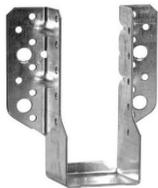
LE SABOT À AILES EXTÉRIEURES SBE PERMET UNE REPRISE DE CHARGE SEMBLABLE AU MODÈLE EN 2 MM D'ÉPAISSEUR. C'EST UN SABOT OPTIMISÉ POUR UNE INSTALLATION PLUS RAPIDE : IL PERMET 20% DE CLOUAGE EN MOINS PAR RAPPORT AU SAE.
